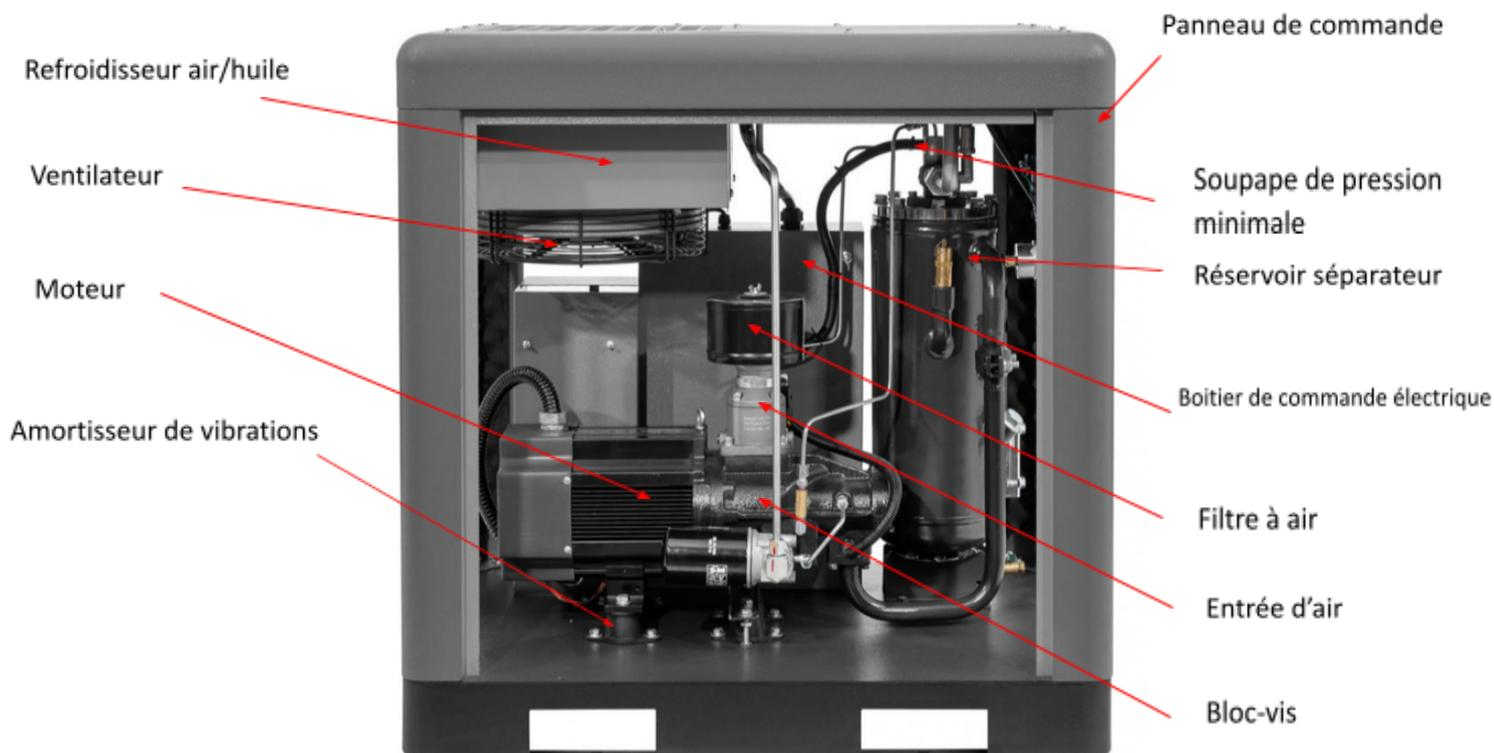
Schéma 1. Compresseur à vis à vitesse variable à entraînement direct
