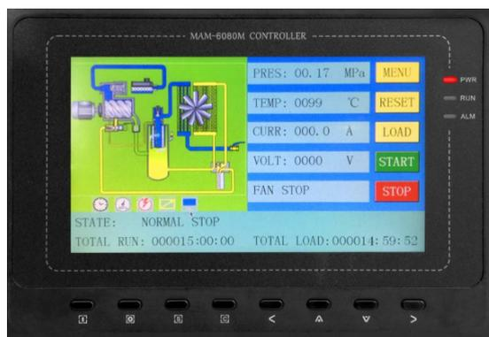
Contrôleur des fréquences variables du compresseur à vis avec onduleur
