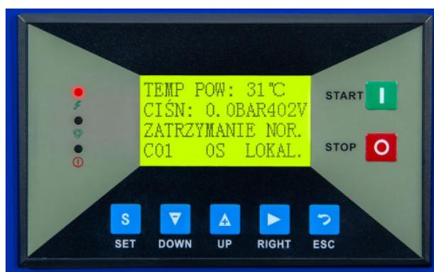
Contrôleur d'un compresseur à vis avec démarreur étoile triangle
