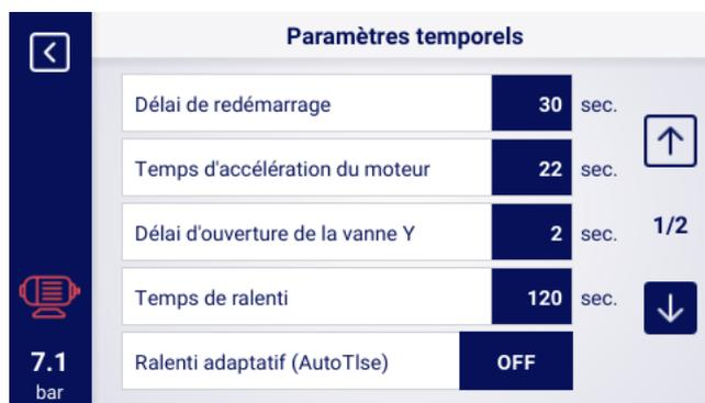
FIGURE 30 – Vue du menu avec les réglages des paramètres temporels pour la configuration de démarrage direct
