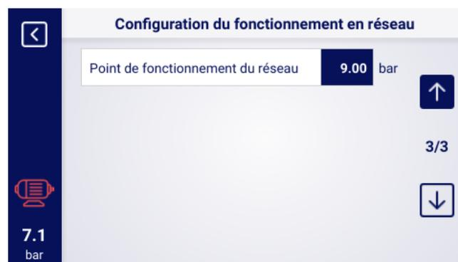
FIGURE 47 – Menu de configuration du fonctionnement du réseau 3/3
