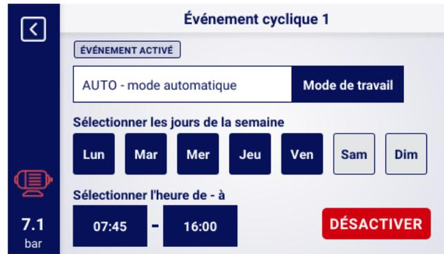
FIGURE 42 – Exemple de configuration d'un événement cyclique
