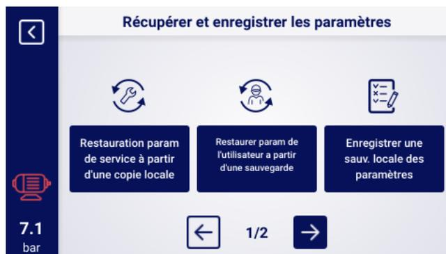
FIGURE 32 – Vue de l'écran de restauration des paramètres à partir du niveau de technicien du service d'entretien
