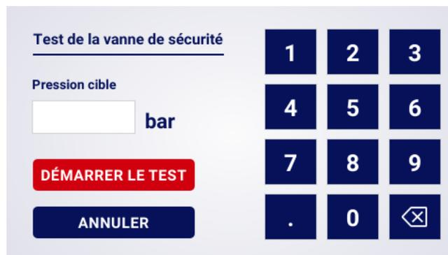
FIGURE 34 – Vue d'écran du contrôleur dans l'onglet de contrôle manuel de la soupape Y
