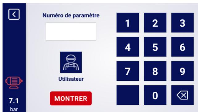
FIGURE 17 – Menu de recherche des paramètres utilisateur
