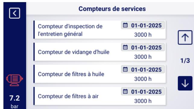
FIGURE 20 – Onglet "Compteurs de service"
