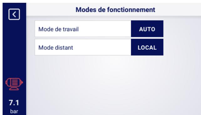
FIGURE 51 – Menu de configuration du mode à distance
