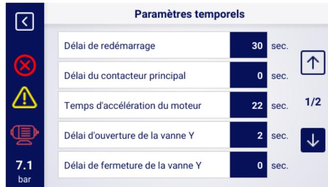
FIGURE 27 – Vue du menu avec les réglages des paramètres temporels pour la configuration de l'onduleur
