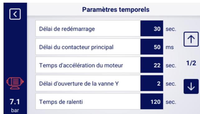
FIGURE 25 – Vue du menu avec les réglages des paramètres temporels pour la configuration Étoile-triangle
