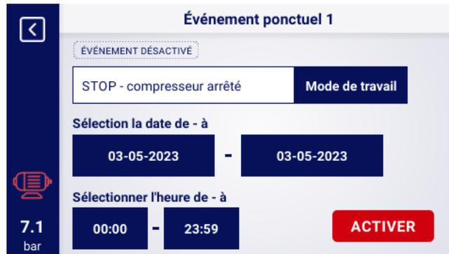
FIGURE 41 – Exemple de configuration d'un événement ponctuel
