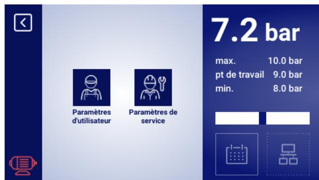
FIGURE 9 – Sélection du niveau d'accès
