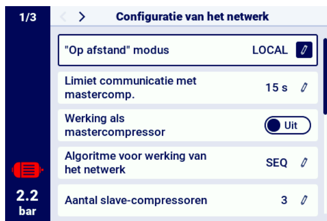
Figuur 12: Tegels met parameters naar het voorbeeld van een subgroep met parameters voor de configuratie van het netwerk
