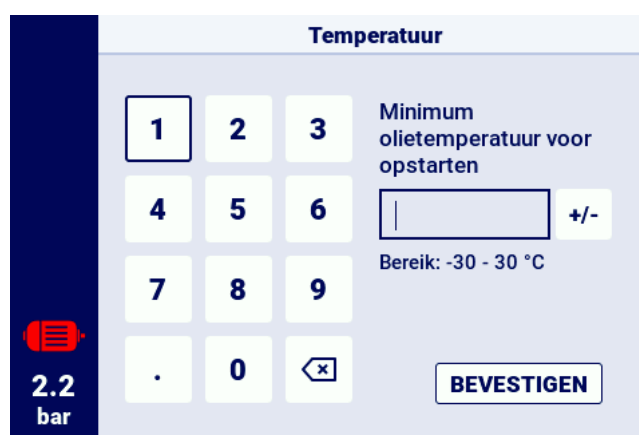
Figuur 13: Het schermtoetsenbord toont het voorbeeld van de minimale olietemperatuur voor opstarten
