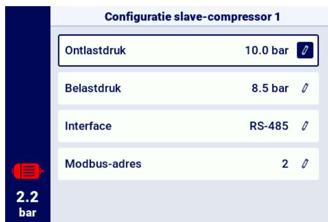
Figuur 42: Configuratiemenu slaafcompressor 1
