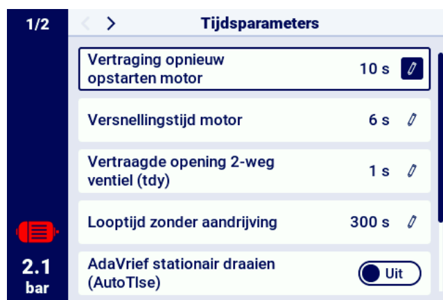
Figuur 30: Weergave van het menu met tijdparameterinstellingen voor Direct Start configuratie
