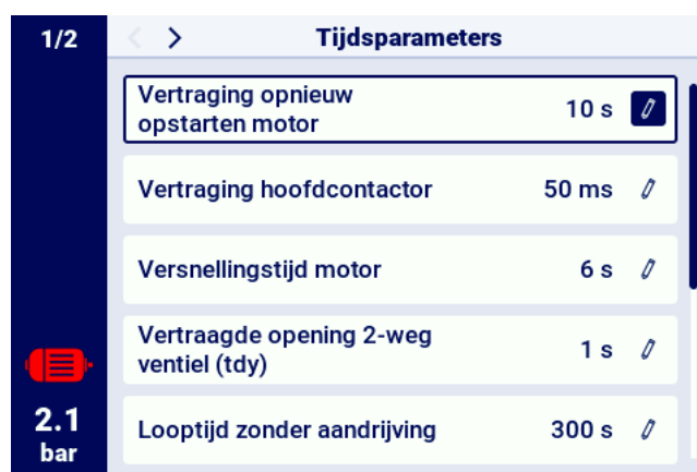
Figuur 25: Weergave van het menu met tijdparameterinstellingen voor de ster-driehoekconfiguratie
