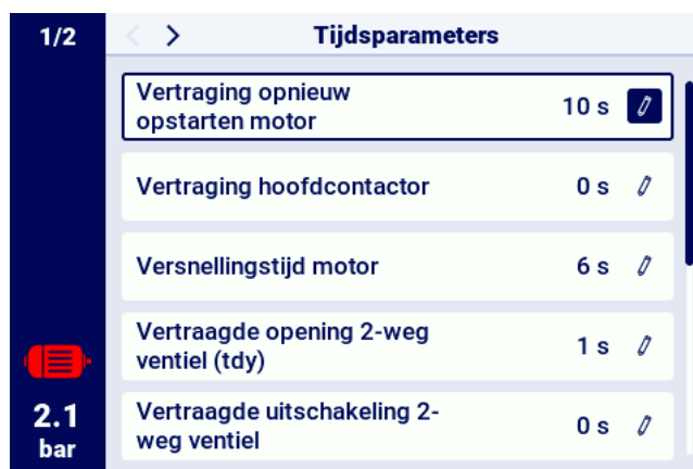
Figuur 27: Menuweergave met tijdparameterinstellingen voor de omvormerconfiguratie
