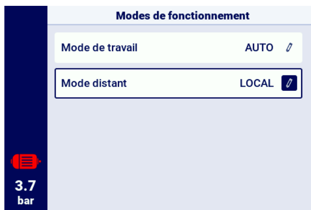
FIGURE 44 – Menu de configuration du mode à distance
