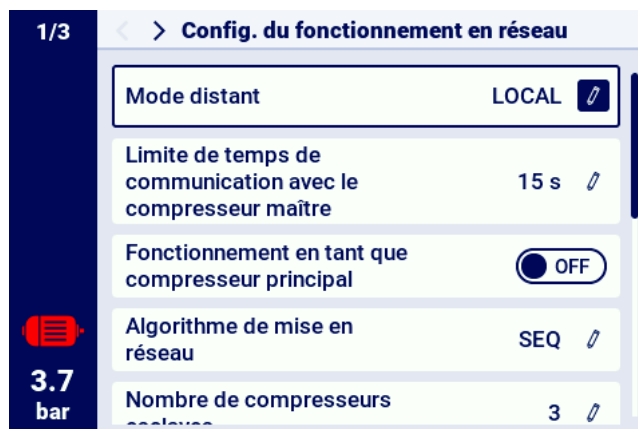
FIGURE 38 – Menu de configuration du fonctionnement du réseau 1/3
