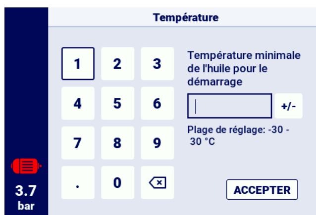
FIGURE 13 – Le clavier à l'écran pour l'exemple de la température minimale de l'huile pour le démarrage
