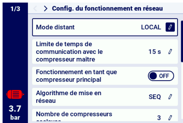
FIGURE 12 – Carreaux de paramètres avec un exemple de sous-groupe de paramètres de configuration du travail en réseau
