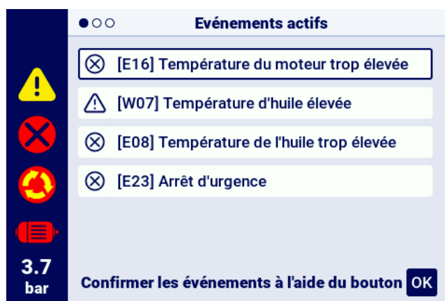
FIGURE 5 – L'onglet des événements actifs est accessible par un changement rapide entre les pages
