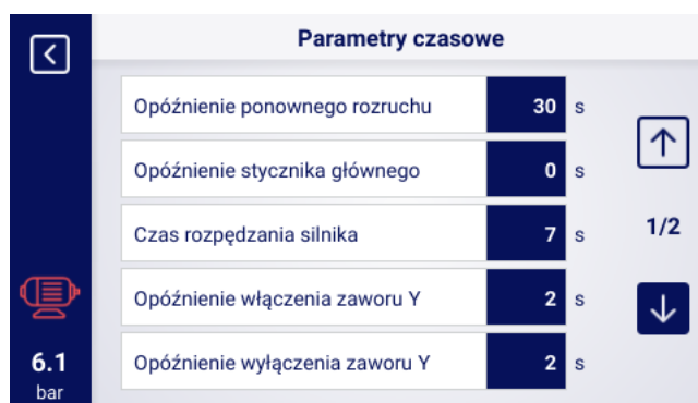
Rysunek 30: Widok menu z ustawieniami parametrów czasowych dla konfiguracji Falownik
