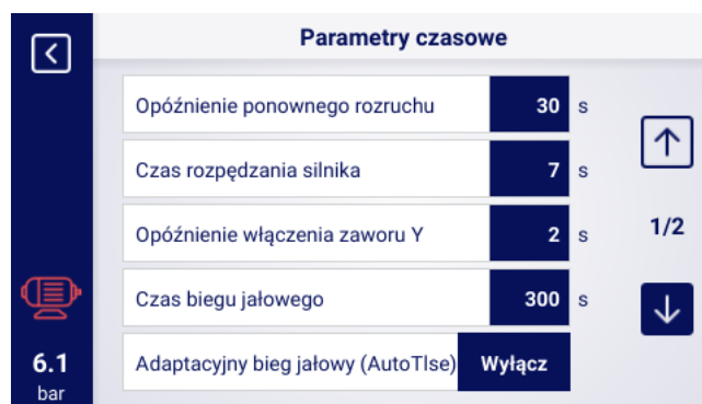
Rysunek 33: Widok menu z ustawieniami parametrów czasowych dla konfiguracji Rozruch Bezpośredni
