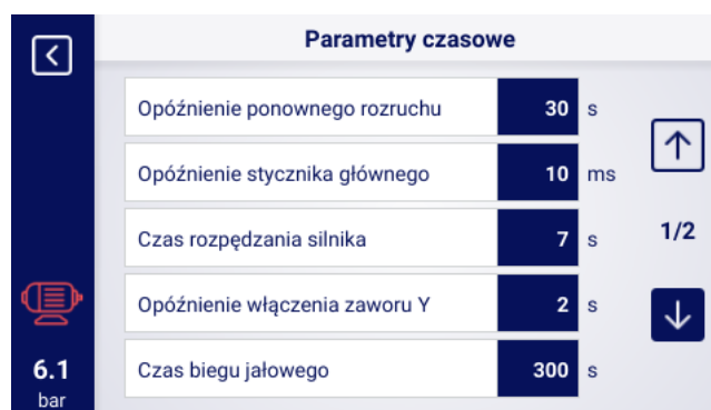
Rysunek 28: Widok menu z ustawieniami parametrów czasowych dla konfiguracji Gwiazda-trójkąt
